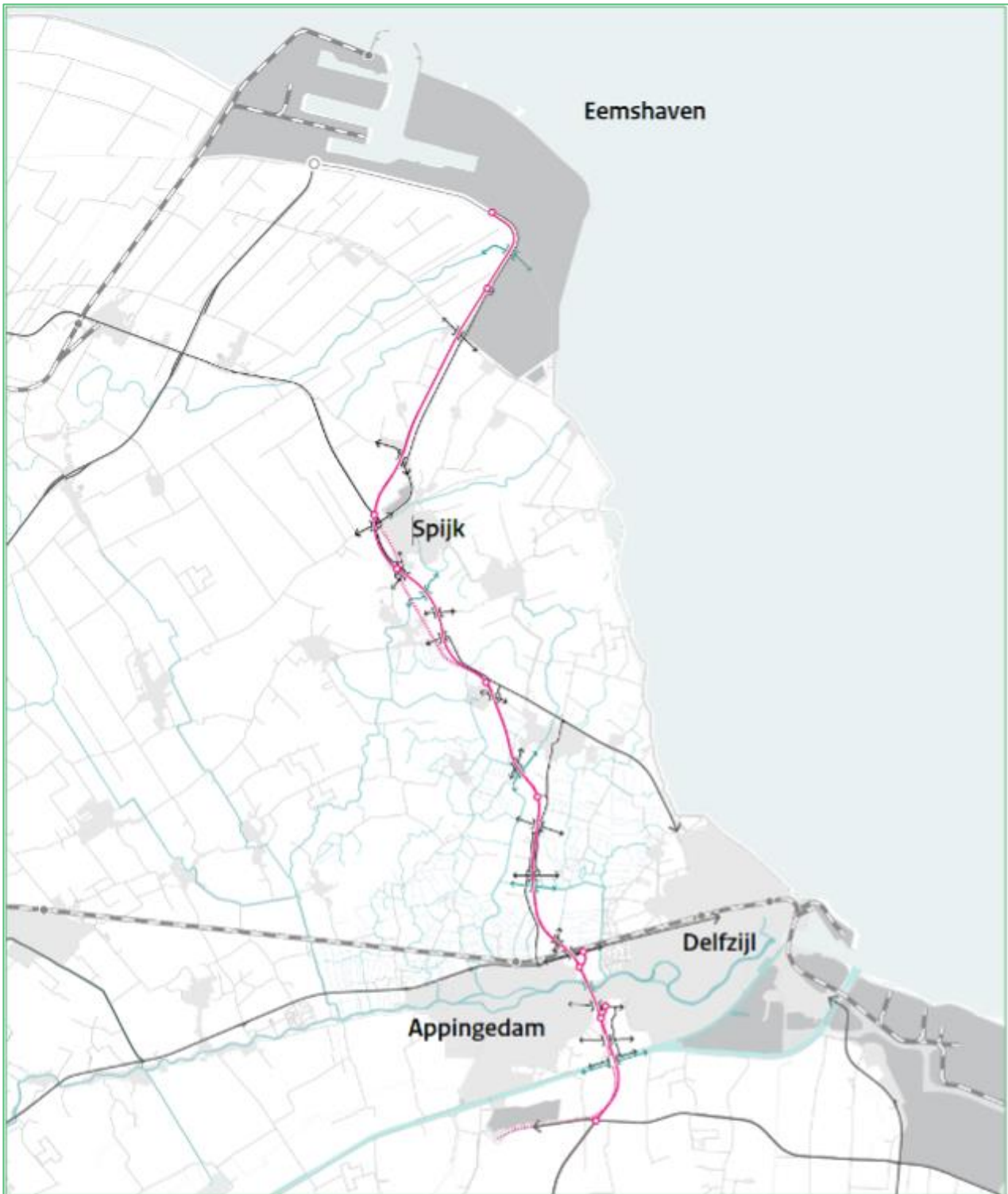
Figuur 6.1: GOW 80 km/u en weergave ligging, 12 directe aansluitingen en onderdoorgangen
